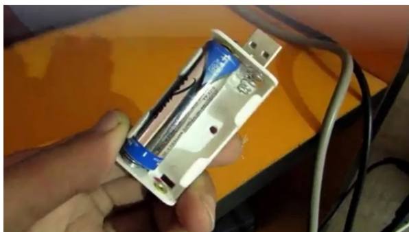
USB-зарядник для Ni-Mh аккумуляторов своими руками
